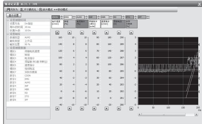
(b) 点击发生报警时的数据的显示按钮，显示报警发生时的各种数据。
