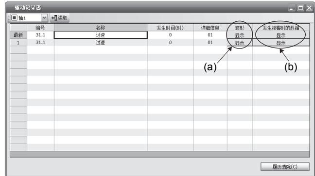
(a) 点击窗口内的波形-显示按钮，报警发生前后的数据在“预览图片”窗口中显示。关于“预览图片”窗口的操作，请参照MR Configurator2的帮助。
